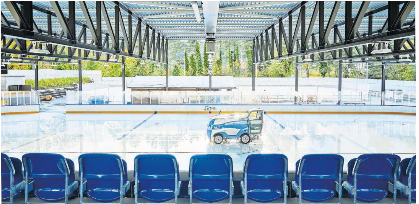
Das überdachte und das offene Eisfeld (im Hintergrund): Die Eisdecke im Tägi wird von 5,5 auf 3 Zentimeter reduziert, um Energie zu sparen.
